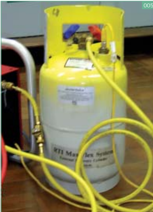
Cilindro de recolhimento de fluido refrigerante com dispositivo de controle de nível e duas válvulas de cores diferenciadas
