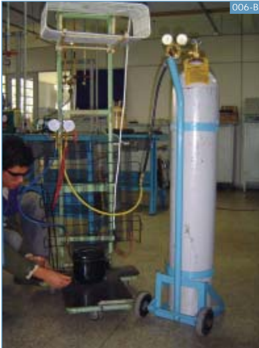
Verificando vazamentos nos pontos de solda utilizando detergente líquido
