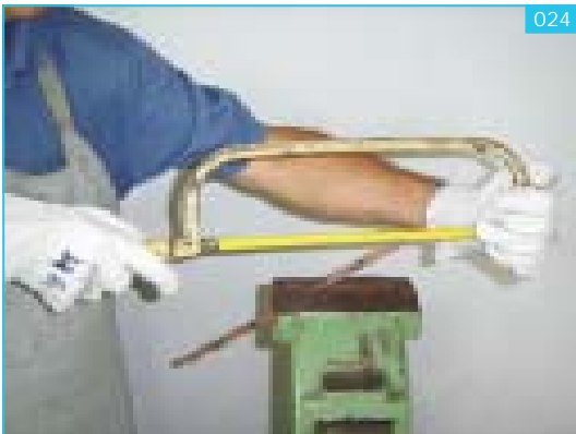
Tubo sendo serrado longitudinalmente para inspeção de brasagem
