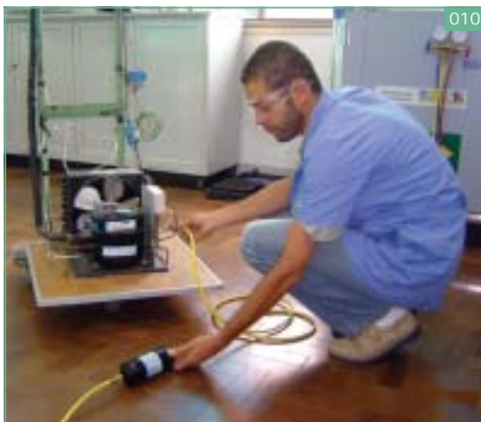
Ligar mangueira com registro 1 entre a válvula de perfuração e o filtro EDF
