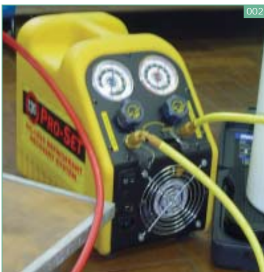
Manifold conectado à unidade de recolhimento
