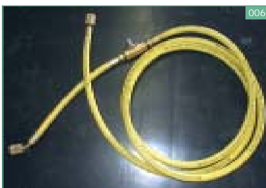
Mangueira com registro
